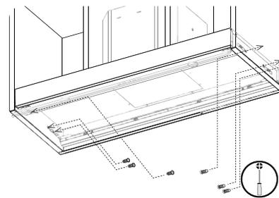
Ce mode de fixation est utilisé pour les hottes dont l'installation ne nécessite pas de découpe de plancher, la façade de la hotte venant se substituer au plancher de meuble. Les dimensions du placard doivent dès lors être parfaitement adaptées à celles de la hotte. Cette dernière se fixe simplement par des vis positionnées sur chaque côté, une fois insérée dans le meuble.
