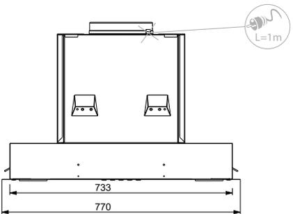
Modèle avec moteur 770 mm
