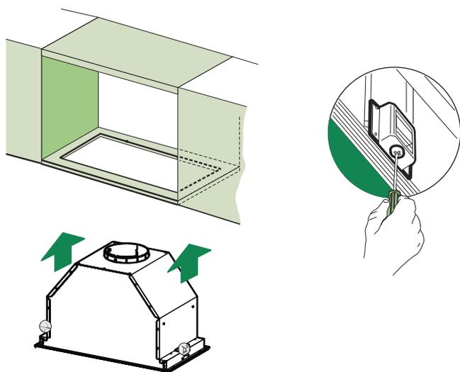
Les groupes de meuble à fixation par pinces nécessitent une découpe de plancher au préalable. Le mode d'installation est très simple car il vous suffit ensuite d'insérer le corps de la hotte dans le meuble et de le fixer simplement à l'aide des pinces situées de chaque côté de la hotte. Ces pinces se clipsent directement sur les parois du meuble et il ne vous reste plus qu'à bloquer leur fixation par vis.
