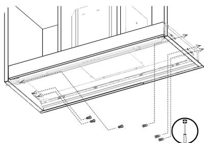
Ce mode de fixation est utilisé pour les groupes de meuble intégrés. Les dimensions du placard doivent être parfaitement adaptées à celles de la hotte. Cette dernière se fixe simplement par des vis positionnées sur chaque côté, une fois insérée dans le meuble.
