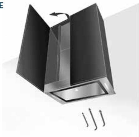
Il est impératif de percer un orifice de sortie de diamètre 150 mm. (sur le dessus du caisson)
