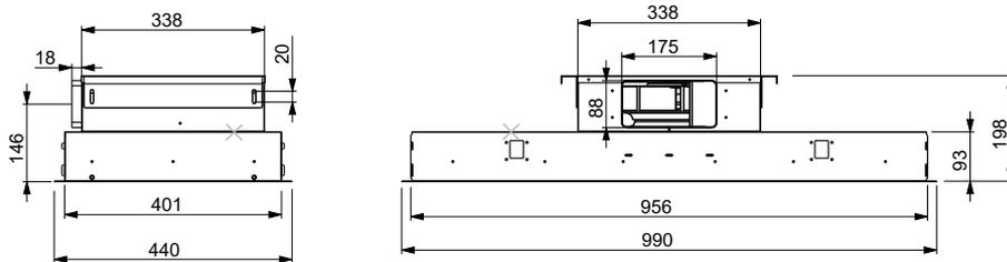
Moteur orientable 360°, sortie en gaine plate sur le côté
